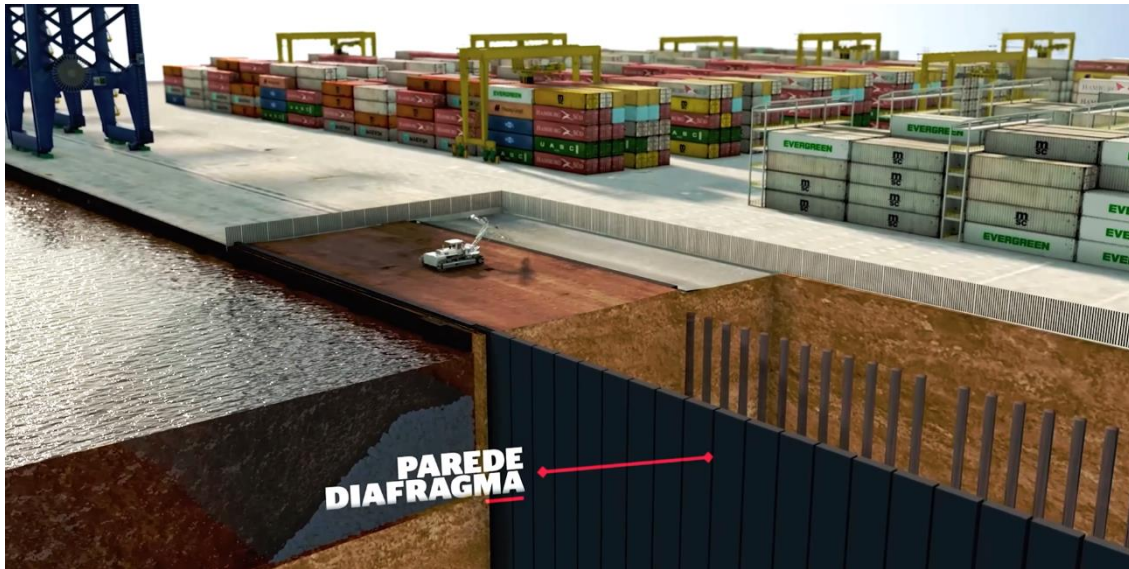
Imagem ilustrativa da parede de diafragma
