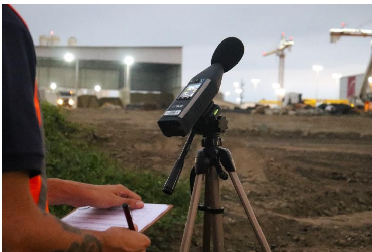
Monitoramento da emissão de ruídos no Canteiro de Obras
